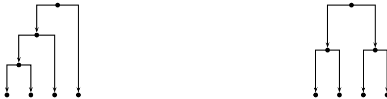
FIGURE 1.5 – Représentation des deux classes d'arbres non isomorphes à quatre feuilles. La première structure comprend douze topologies différentes et la deuxième trois, suivant l'ordre choisi pour les feuilles.
