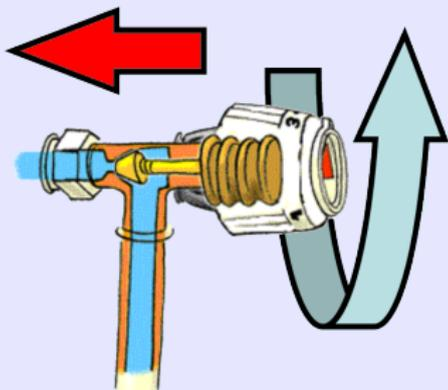
**En tournant le robinet dans le sens DIRECT on FERME la canalisation**
