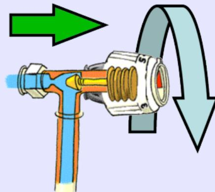
**En tournant le robinet dans le sens INDIRECT on OUVRE la canalisation**
