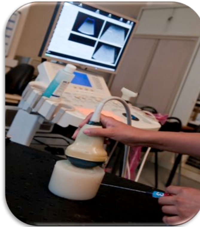
Plateforme d' imagerie ultrasonore 6 échographes RF (4-20MHz) de recherche, banc d'acquisition automatisé, réalisation de fantômes physiques
