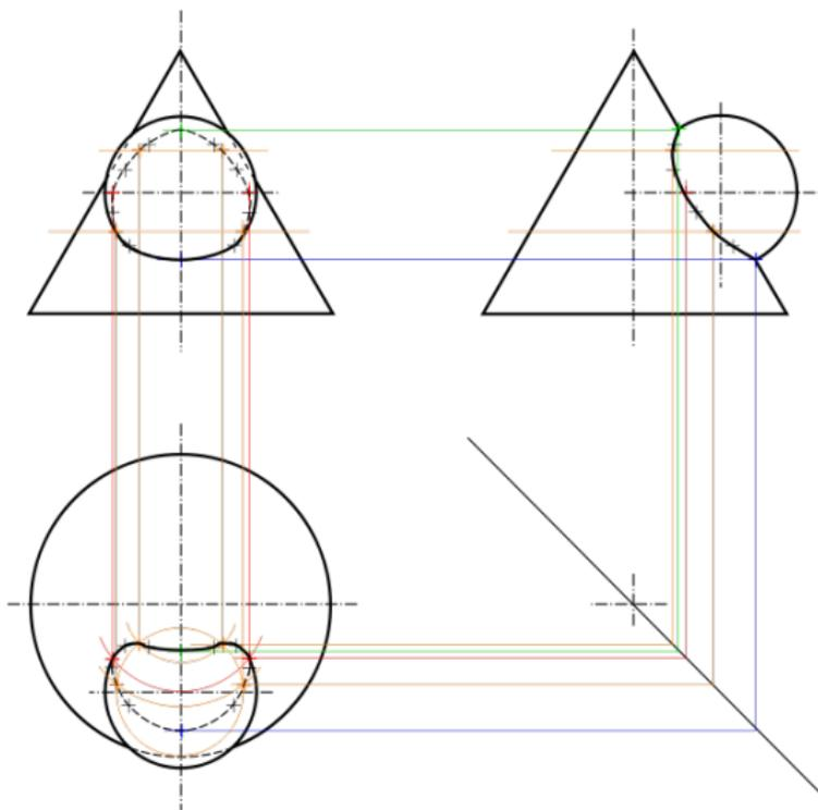
*Un exemple : l'intersection d'un cône et d'une sphère.*
