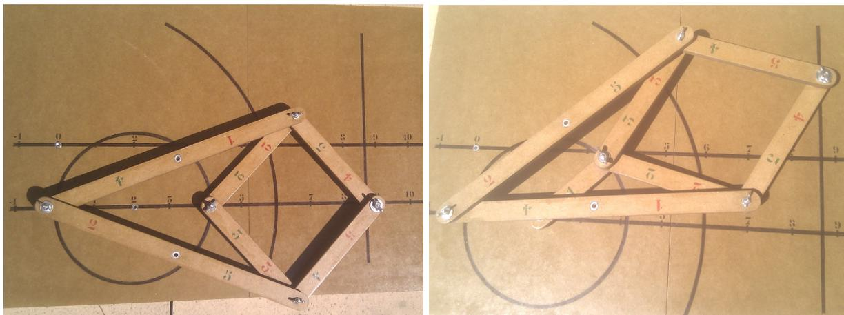
FIGURE 3 – L'inverseur de Peaucellier réalise une inversion par rapport à un cercle (photo de gauche). Les chiffres bleus indiquent la hauteur des tiges. En ajoutant la petite barre en bois notée 1 (photo de droite), on le transforme en un mécanisme qui trace une ligne droite.
