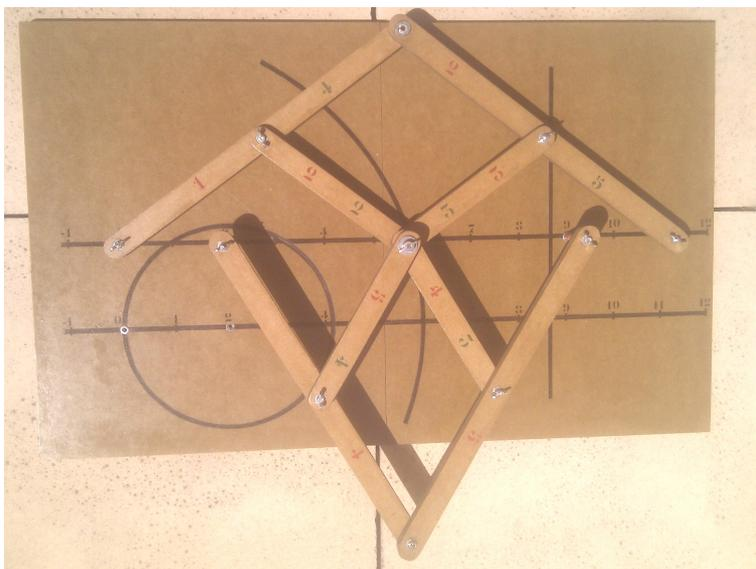
FIGURE 2 – L'additionneur est composé de deux pantographes : un en haut et un en bas. Pour la construction, les chiffres rouges indiquent la hauteur des tiges. Le chiffre 1 correspond à la barre la plus basse, elle n'est que légèrement surélevée par rapport au plateau.
