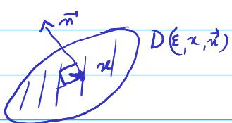
Notons  $F(\epsilon, x, \vec{m})$  la force exercée par le fluide situé du côté où  $\vec{m}$  pointe sur  $D(\epsilon, x, \vec{m})$ .
