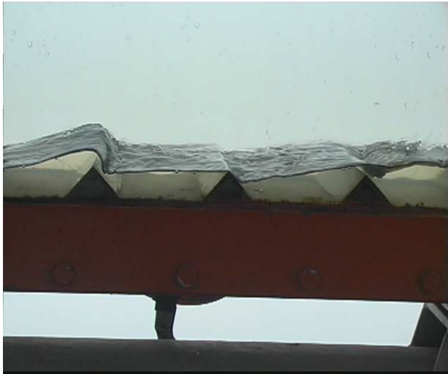
FIG. 1 – Instabilité des ondes de surfaces sur un fond périodique D. Astruc, N. Dolez, O. Thual Photo : A.L. Le Fessant, thèse 2001 de l'IMFT.
