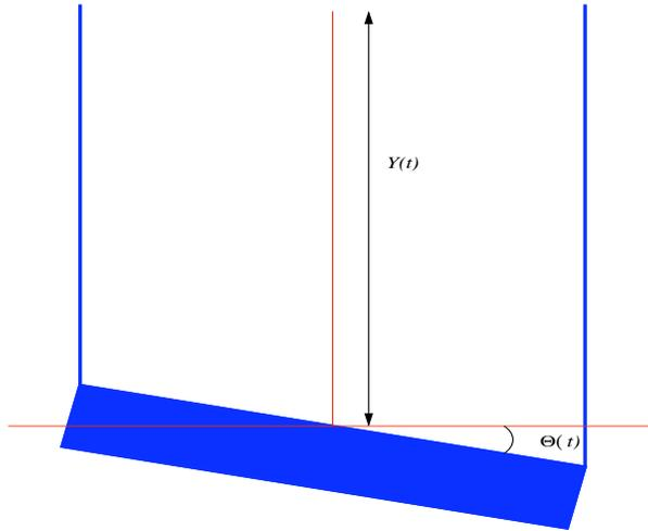
Figure 2: Étude du mouvement d'un pont à l'aide d'une équation aux dérivées ordinaires.
