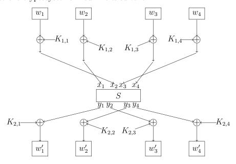
La S-boîte est donnée par le tableau suivant (entrée :  $x_1x_2x_3x_4$ , sortie :  $y_1y_2y_3y_4$ )
