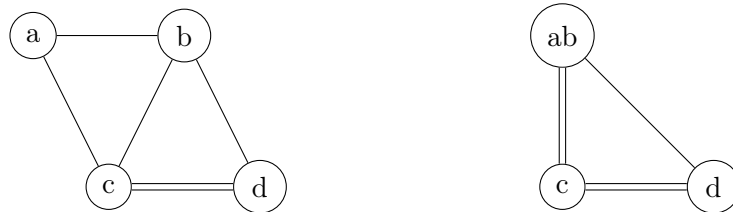
FIGURE 1 – Un graphe G (à gauche) et sa contraction G/e pour e = \{a, b\} (à droite)
