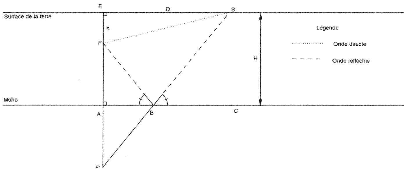
On note  $E$  l'épicentre du séisme,  $h = EF$  la profondeur du foyer,  $D = ES$  la distance entre la station et l'épicentre,  $B$  le point de réflexion de l'onde sismique,  $A$  l'intersection entre le Moho et la droite  $(EF)$  et  $C$  un point de  $[AB)$  qui n'est pas sur  $[AB]$ . On note également  $F'$  le symétrique de  $F$  par rapport à  $A$ .
