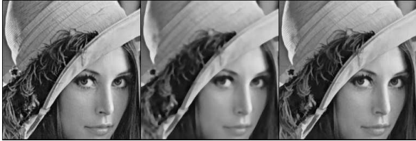
FIG. 2 – Image originale u - \text{med}_{B(.,3)}u - (\text{MFCN}_{20})^{10}(u) Cette expérience illustre le fait que MFCN préserve les structures cohérentes d'une image y compris lorsque le filtrage est effectué sur un grand voisinage (40 pixels au total). Appliqué à un voisinage de taille équivalente, le filtre médian classique altère considérablement l'image dès la première itération. En outre le résultat obtenu par MFCN est un point fixe .
