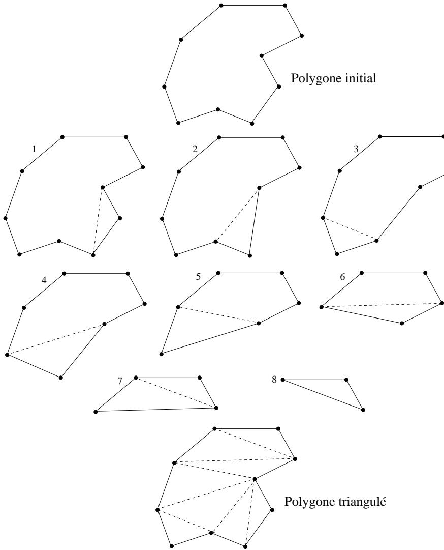
FIG. 3.10: *Triangulation d'un polygone*
