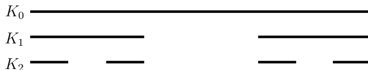
Construction de l'ensemble triadique de Cantor.
