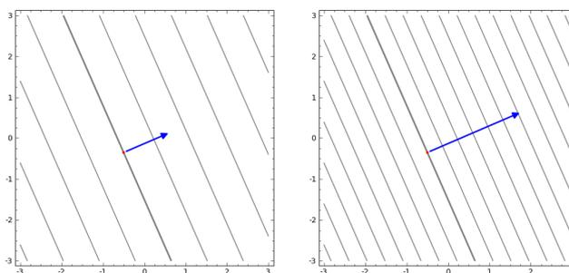
FIGURE 4 – Lignes de niveaux d'une fonction affine et gradient en un point
