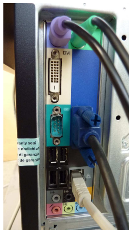
Connectique ordinateur PC avec port série 9 broches
